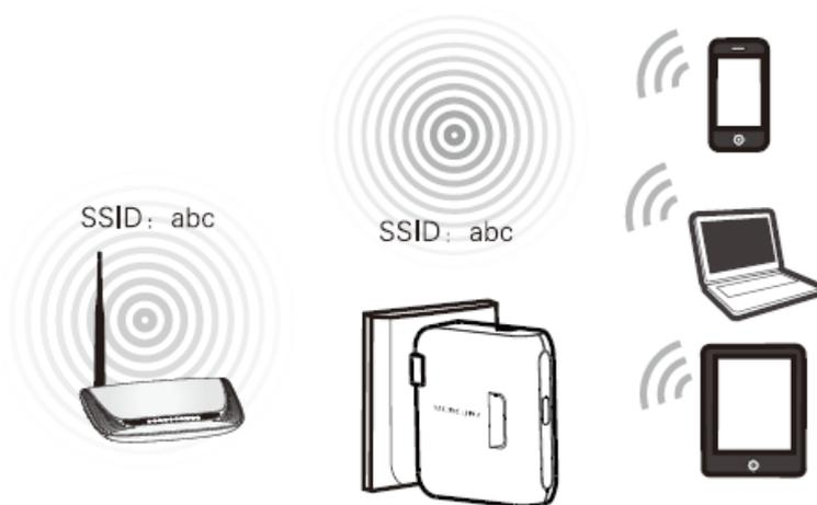
图 4-3 Repeater 模式连接图
