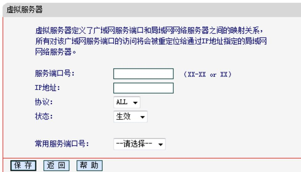
图 9-25 设置虚拟服务器条目
