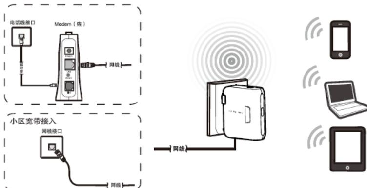
图 4-2 Router 模式连接图
