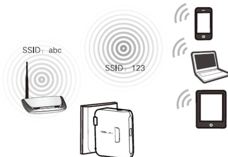
图 4-4 Bridge 模式连接图
