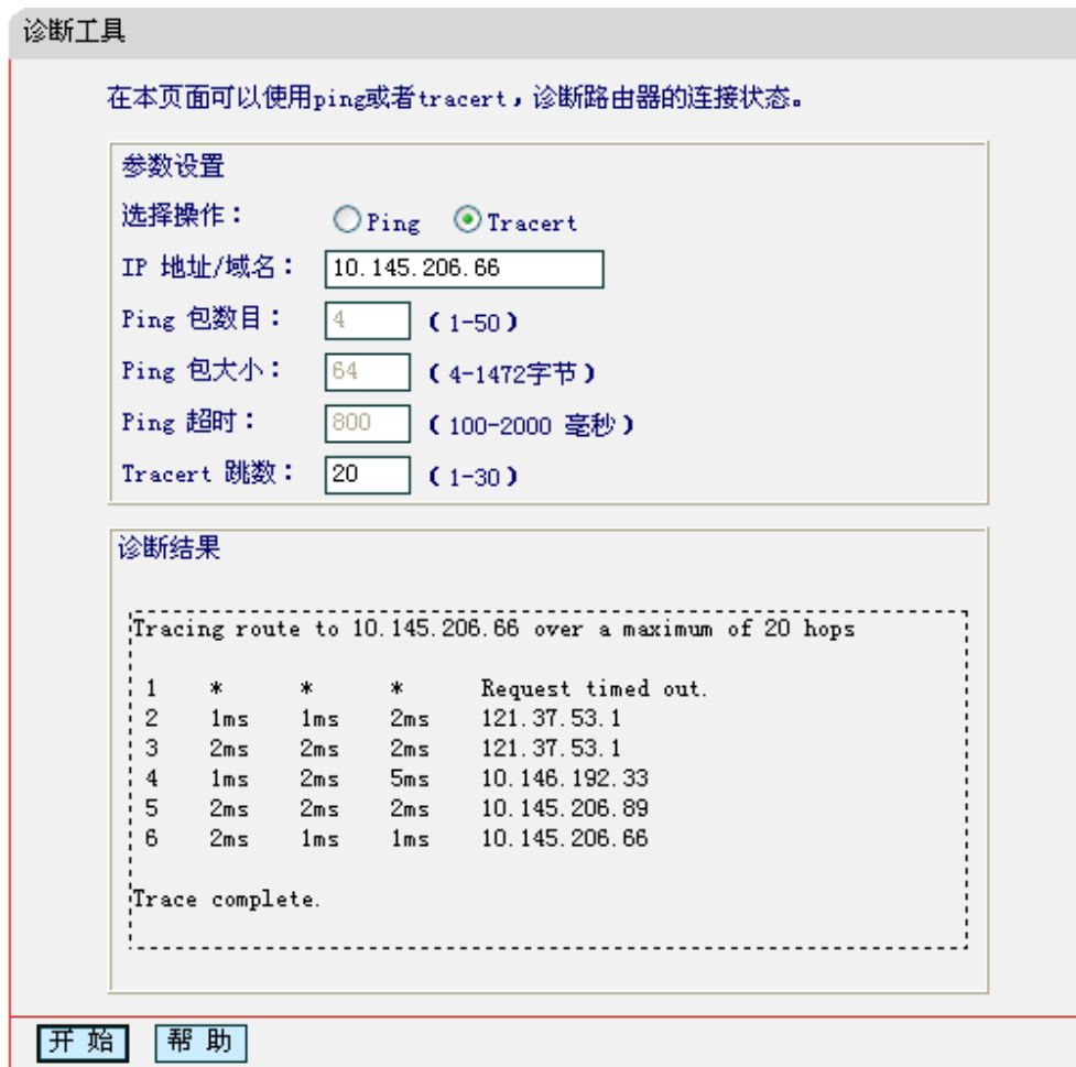
图4-58 Tracert 诊断结果—成功
