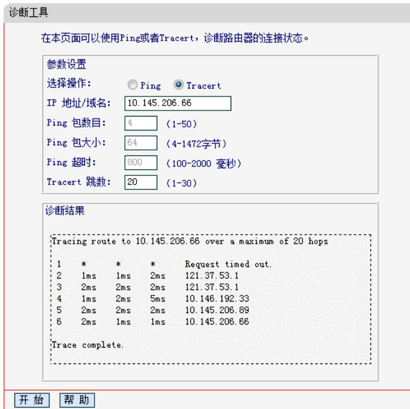
图 5-57 Tracert 诊断结果—成功
