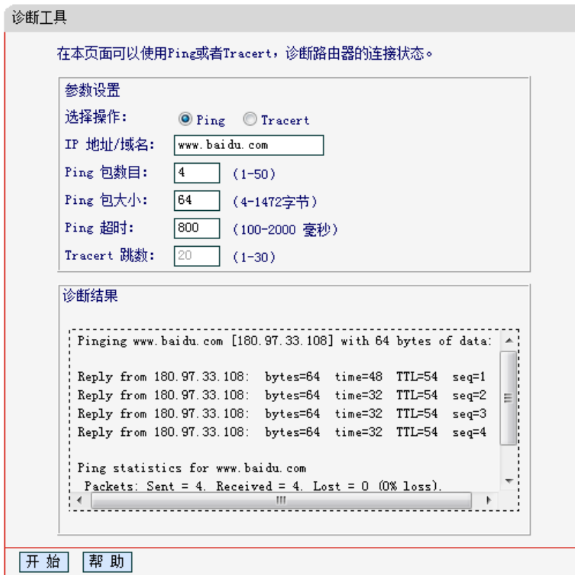
图 5-55 Ping 诊断结果—成功
