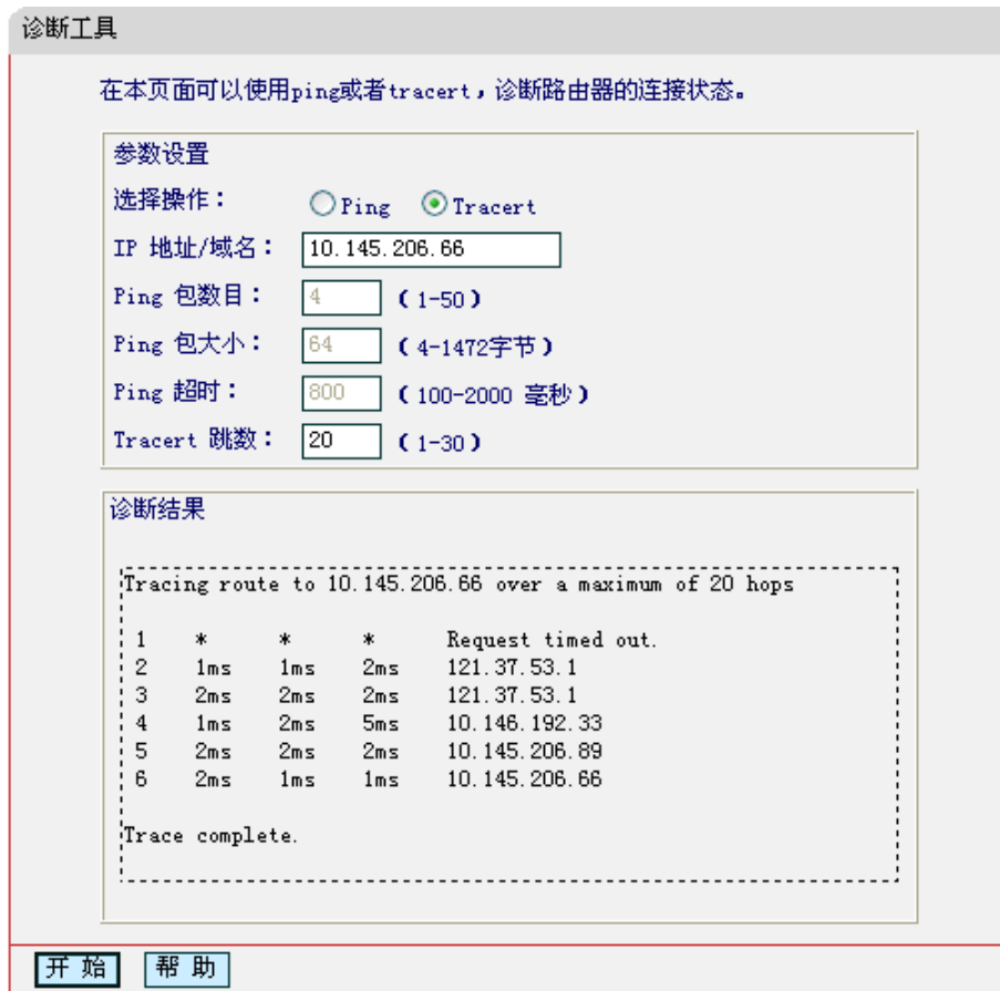
图 4-76 Tracert 诊断结果—成功
