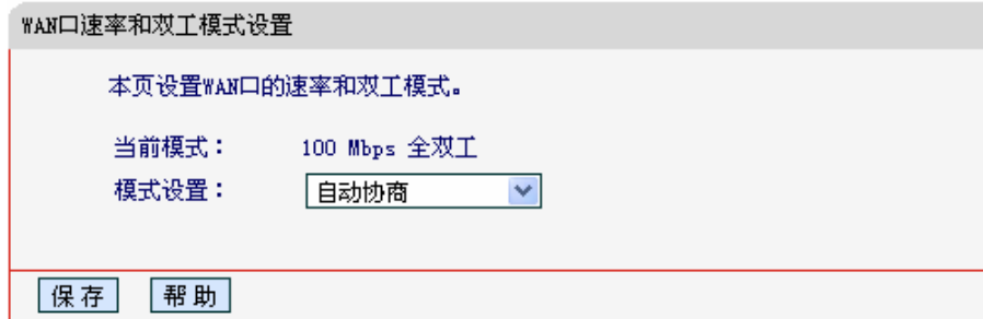
图4-11 WAN口速率和双工模式设置
