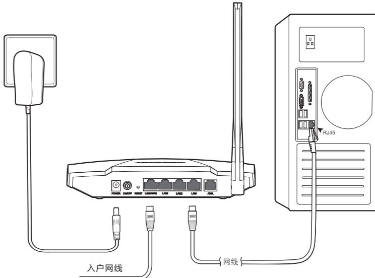
连接完成后，请检查指示灯是否正常。如果指示灯显示不正常，请检查连接是否正确。
