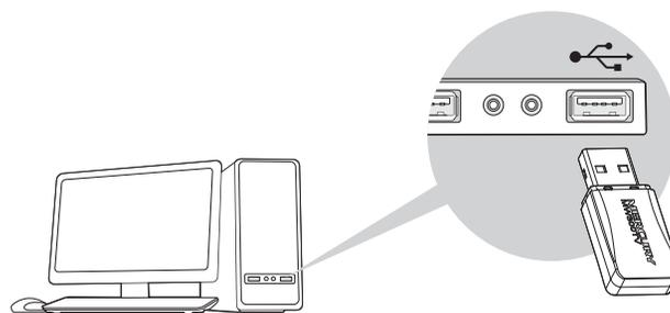
将网卡插入USB口, 若弹出“新硬件安装向导”, 点击“取消”。
