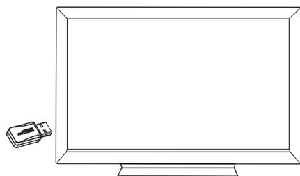
与 MW300TV 兼容的电视机不需要安装软件, 插上 MW300TV 后在电视机上进行设置, 连接到您的无线网络即可使用。
