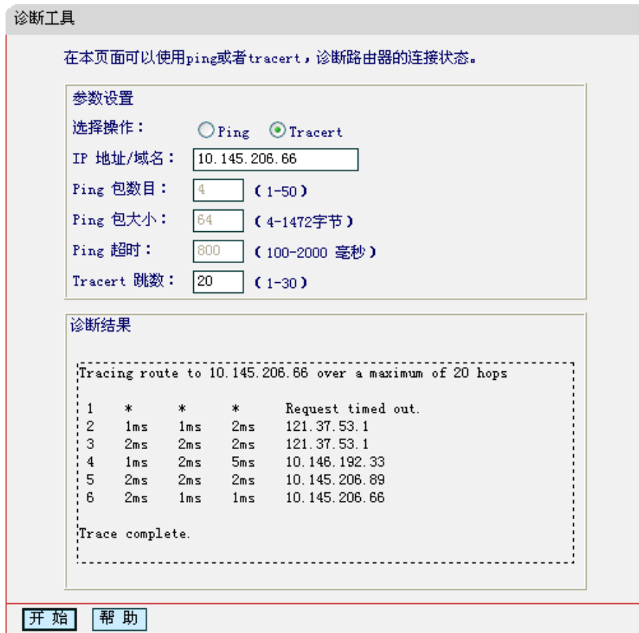
图 4-70 Tracert 诊断结果—成功
