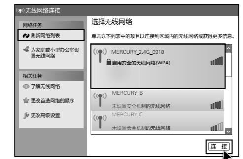
③ 输入刚才在“设置路由器”的步骤7中设定的无线网络密码，单击“连接”。
