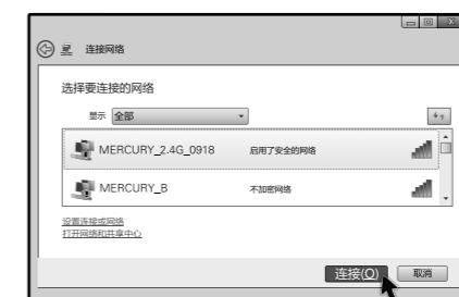
③ 请按照提示输入刚才在“设置路由器”的步骤7中设定的无线网络密码，单击“确定”。当画面提示成功连接时，表示电脑已成功加入该网络。
