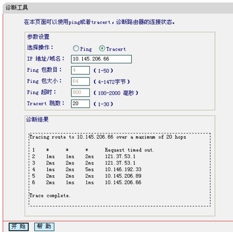
图 4-77 Tracert 诊断结果—成功
