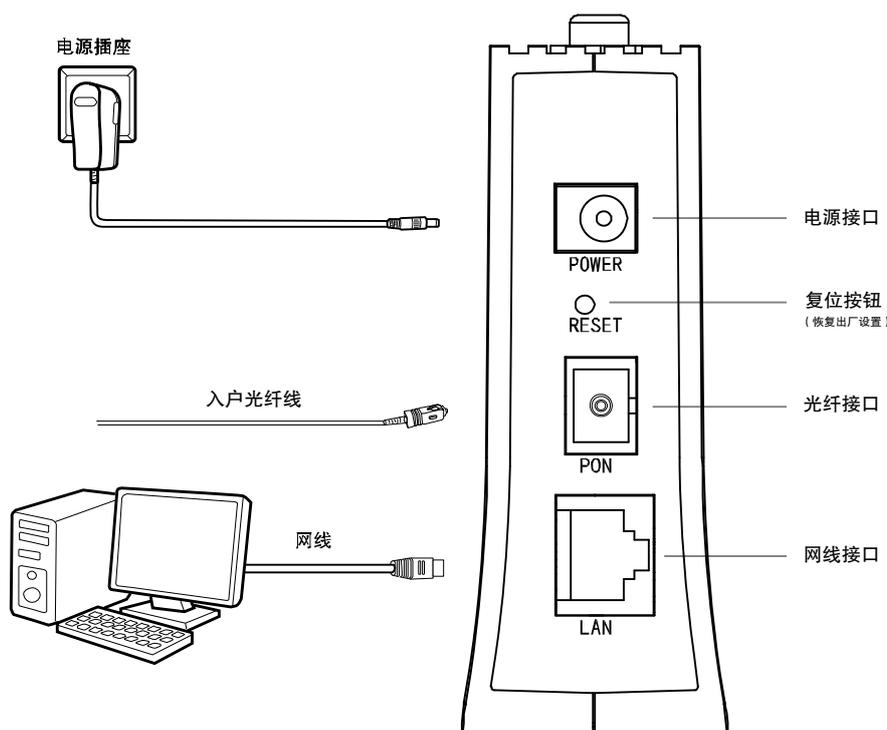
图 3-1 MG610 硬件安装示意图
