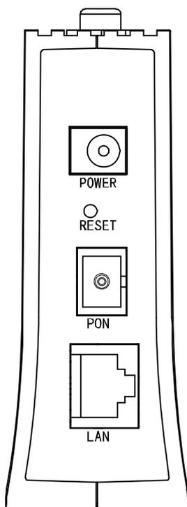
图 2-2 MG610 后面板示意图
