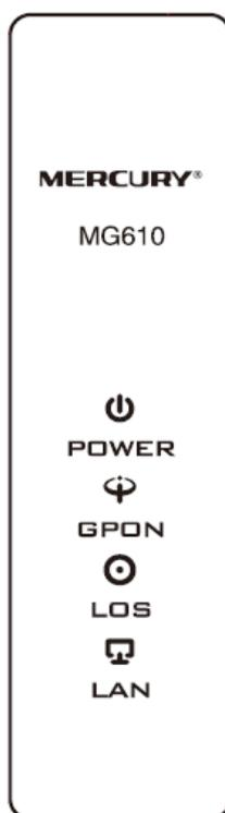
图 2-1 MG610 前面板示意图
